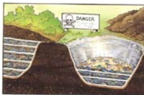
Le fond du trou doit être plat. Les déchets (emballages rincés et perforés) seront disposés par couches en alternant le dépôt avec des couches de terre pour favoriser l'action de décomposition par les micro-organismes du sol. Ne pas laisser les déchets déposés dans la fosse non recouverts de terre.
