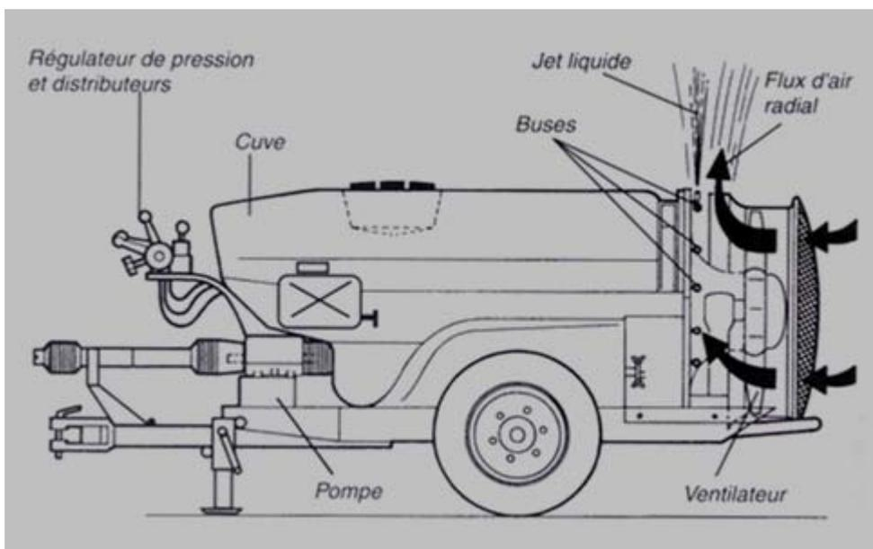
La bouillie est d'abord fragmentée en gouttelettes par la pression de liquide au niveau des buses. Dès leur sortie des buses, les gouttes sont prises en charge et entraînées par le courant d'air du ventilateur qui les transporte vers le feuillage à traiter.
