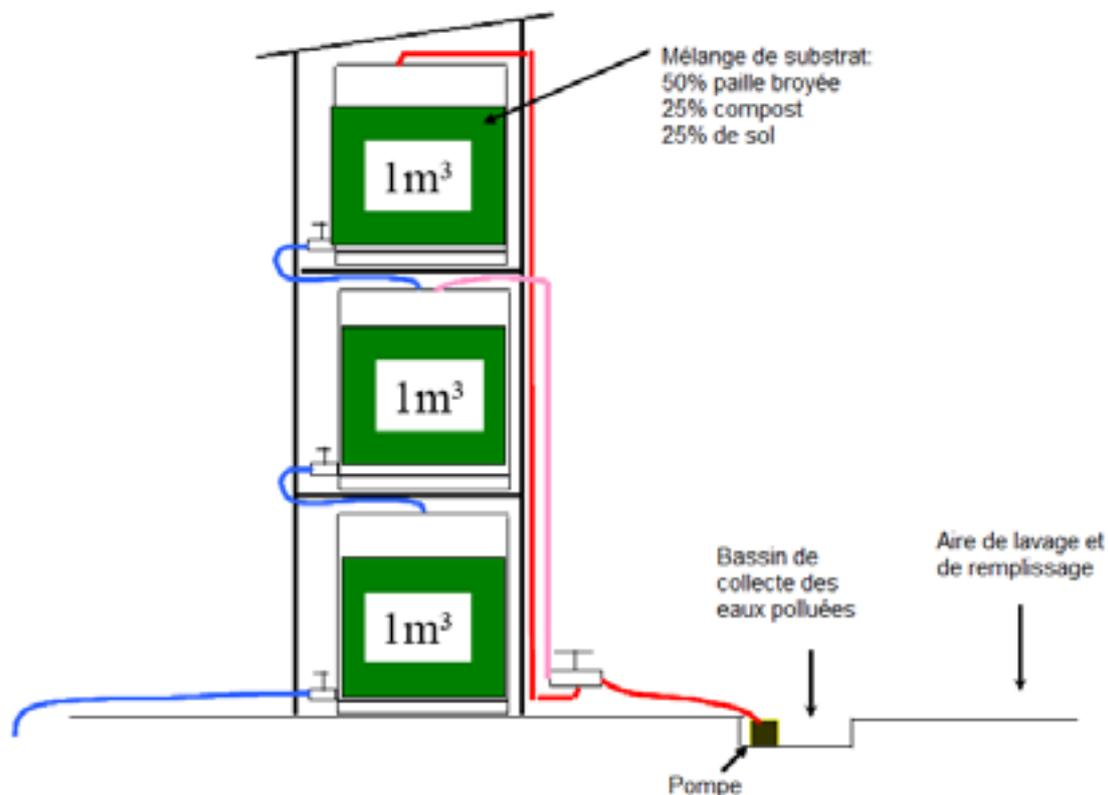
l'effluent après la filtration. Le système prend peu de place, les 3 bacs étant placés en hauteur, et consomme peu d'énergie car l'eau circule par gravité. L'effluent chargé est pompé dans le bac supérieur. Il y séjourne quelques heures, puis la vanne est ouverte et l'effluent peut passer dans le bac immédiatement inférieur.
