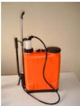
La plupart des petits producteurs utilisent pour traiter leur culture **un appareil à pression entretenue par un pompage manuel, porté sur le dos**. Son principe de fonctionnement et de réglage est très simple et sera décrit dans le détail au prochain chapitre.
