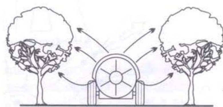
Selon les matériels, le débit d'air varie de 3 à 25 m<sup>3</sup>/s et sa vitesse périphérique à la sortie du ventilateur peut varier de 30 à 60 m/s (de 100 à 250 km/h) selon le débit et le réglage de la section de sortie. Ce mode de fonctionnement est commun à tous les pulvérisateurs classiques à jets portés placés en sortie de turbine.
