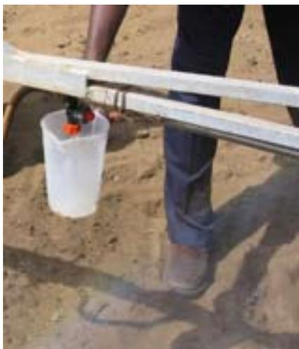
*Test de débit des buses et de la rampe avec de l'eau claire, après rinçage soigné de l'appareil.
