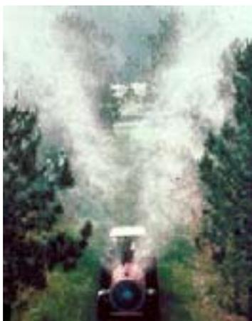
La fragmentation de la bouillie est obtenue par pression du liquide dans des buses et le transport des gouttes est assuré par un courant d'air.
