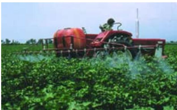
La structure peut également être renforcée par un assemblage en treillis, en triangle ou en trapèze. Différents dispositifs de suspension améliorent la stabilité de la rampe. Un tronçon de rampe est une portion de canalisation ayant sa propre alimentation en bouillie. Le choix du nombre de tronçons dépendra essentiellement de la largeur de la rampe.
