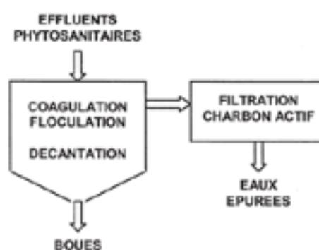
Contrairement aux stations fonctionnant en continu, le système SENTINEL traite les effluents par batch. Le procédé SENTINEL amène à concentrer les polluants dans les boues et le charbon actif. Pour 1 000 litres d'effluents bruts traités, on obtient en moyenne :
