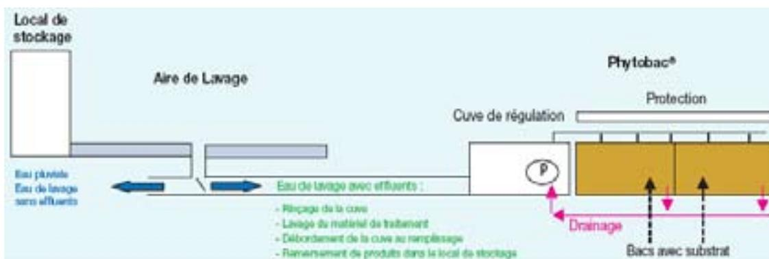
L'apport des effluents peut se faire directement au-dessus de ce dispositif, ou à partir de l'aire de lavage du matériel de pulvérisation par l'intermédiaire de conduits spécifiques. Dans ce cas, il convient de prévoir un système de collecte des effluents au niveau de l'aire de remplissage et de lavage du matériel de pulvérisation. Cette aire doit être facile d'accès et éloignée des points d'eau permanents ou temporaires.
