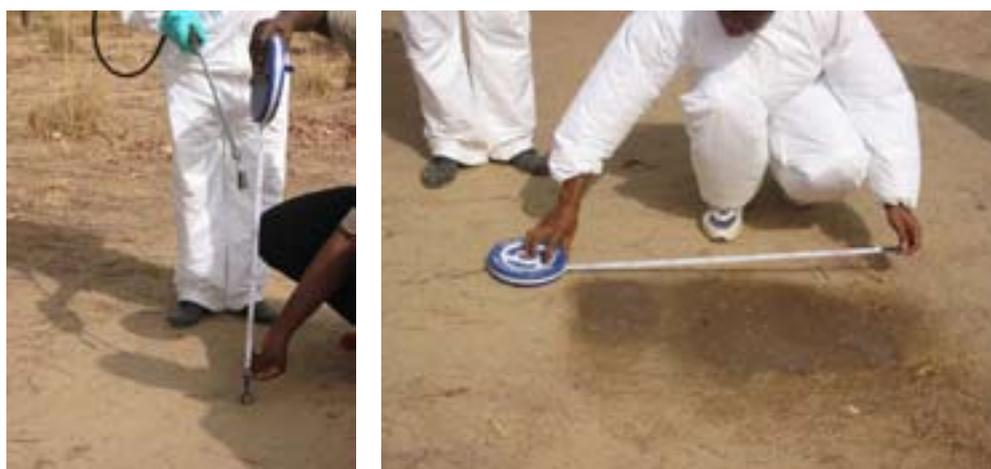
*Pour mesurer la largeur de travail, pulvériser un sol bien sec avec de l'eau à la hauteur de travail prévue. Mesurer la largeur de la trace sur le sol.*
