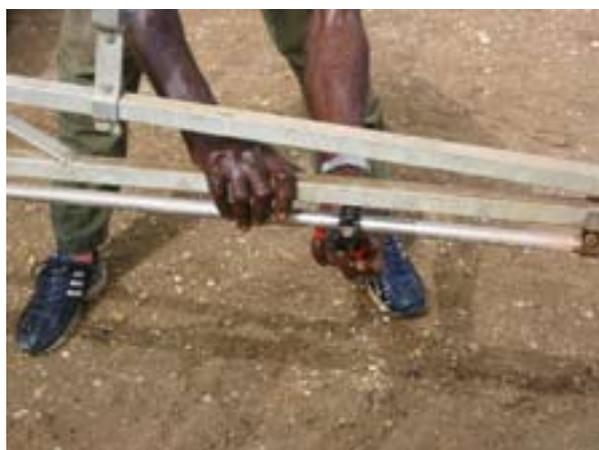
*Ne pas démonter les buses d'un appareil en fonctionnement et ne pas démonter sans porter de gants.*
