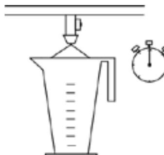
*Mesure du débit d'une buse dans un pot
