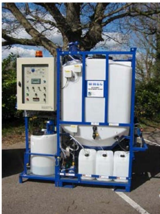
*Pour traiter les effluents phytosanitaires issus de traitements post-récolte, le dispositif SENTINEL conçu par WMEC (UK).*
