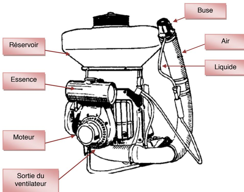
Un moteur de faible cylindrée entraîne **un ventilateur** qui produit un **flux d'air à faible volume et vitesse élevée**. Un dispositif Venturi placé dans la tuyère permet **l'aspiration de la bouillie** hors du réservoir qui est refoulée à faible pression au travers d'un tuyau directement au niveau de la sortie d'air où il est « atomisé » et dirigé vers la cible.
