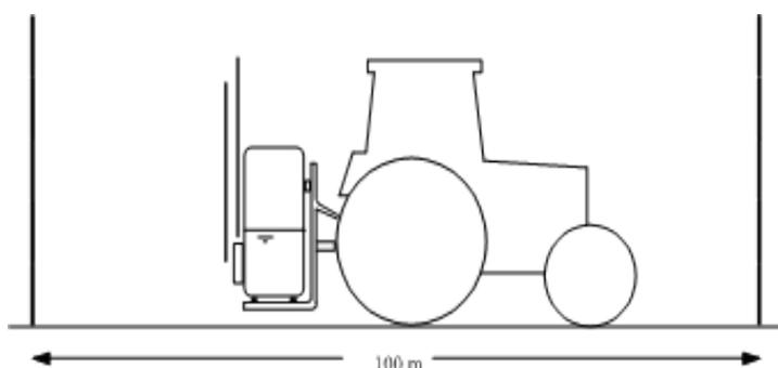
La **vitesse d'avancement** et l'**écartement entre les buses** permettent de déterminer le **débit nécessaire** pour obtenir le **volume/hectare** choisi.
