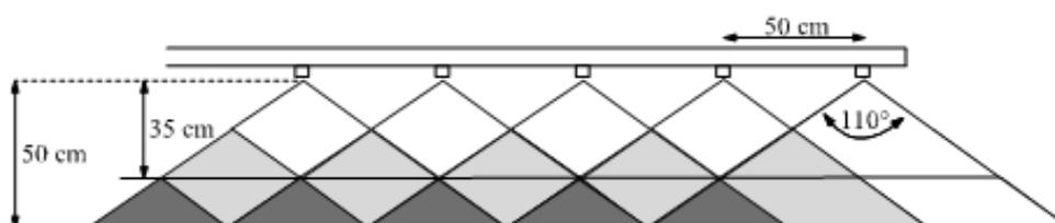
Avec les buses à turbulence, on choisit également une hauteur de rampe qui donne un recouvrement des jets. Pour des buses espacées de 50 cm avec un angle nominal du jet de 80°, la hauteur optimale se situe entre 70 et 90 cm de la cible, bien qu'il soit difficile d'obtenir une bonne répartition avec ce type de buse.
