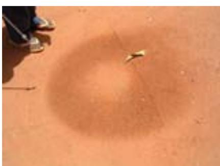
Trace laissée au sol par une buse à turbulence. Le jet forme clairement un cône creux. Les plus fines gouttes se retrouvent à l'extérieur du jet et sont entraînées par le vent (dérive). Ce type de jet turbulent convient bien pour traiter avec des fongicides car les fines gouttes peuvent adhérer à la face inférieure des feuilles. (Photo B. Schiffers)
