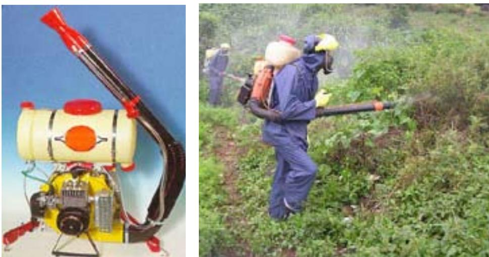
La structure des exploitations agricoles et l'encadrement technique disponible laissent cependant peu de place au développement d'une mécanisation motorisée très poussée. Les parcelles cultivées ont généralement une superficie réduite et sont souvent dispersées et d'un accès difficile. Seuls, les appareils de poids limité, portés sur le dos de l'opérateur conviennent à cette situation.
